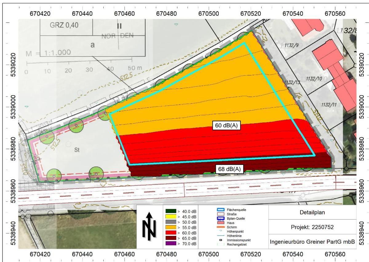
**Verkehrsgeräusche: Rasterlärmkarte Tag (Freibereich, Höhe 1,5 m, FFB 17 V<sub>zul</sub> 50 km/h) mit Abschirmung (Höhe 2,0 m über GOK)**
